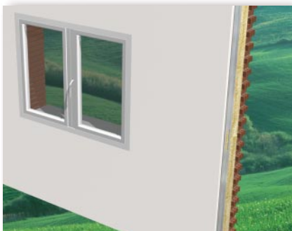
Trasdosado de fachada
